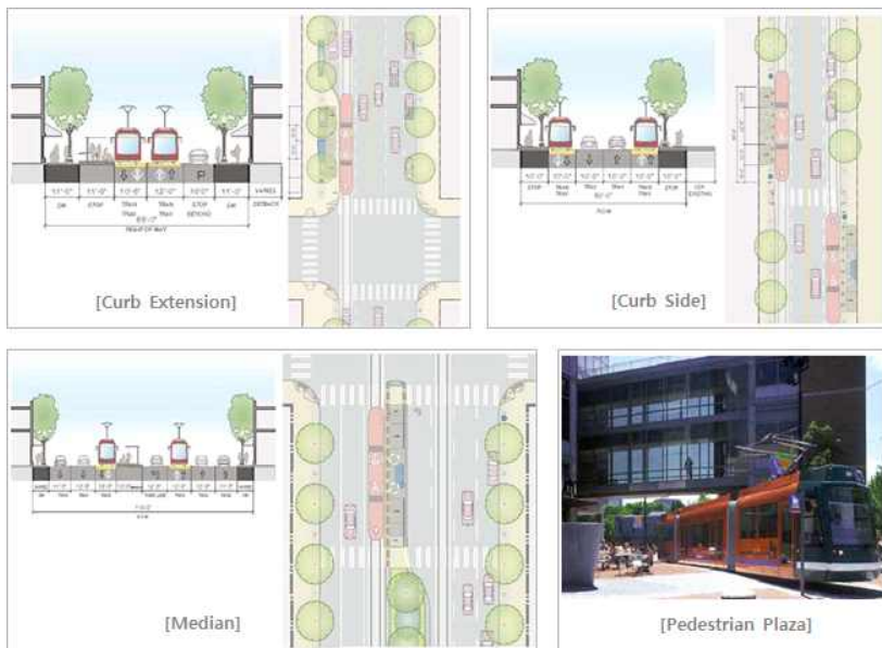
〈그림 2-4〉 플랫폼의 종류 자료 : DC Streetcar Design Criteria
